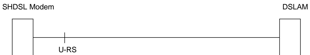
Abbildung 2.2.1 Schematische Darstellung eines SHDSL Anschlusses
