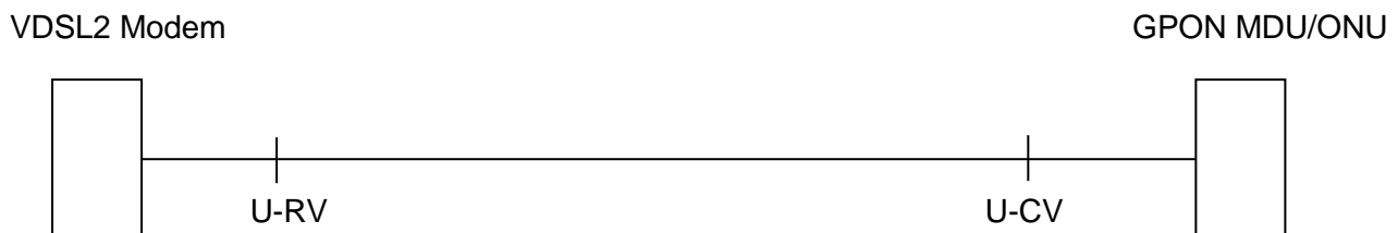
Abbildung 2.3.1 Schematische Darstellung eines VDSL2 FTTB Anschluss
