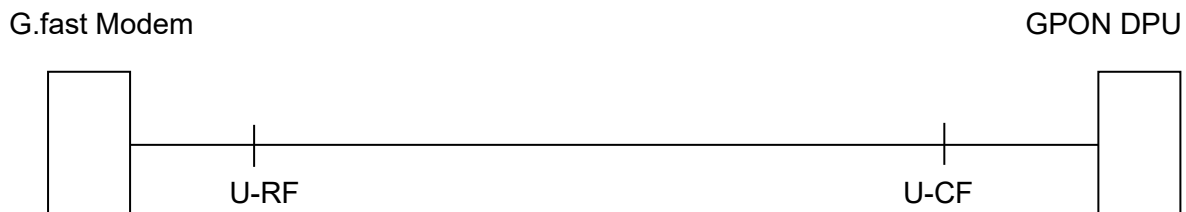
Abbildung 2.4.1 Schematische Darstellung eines G.fast FTTB Anschluss
