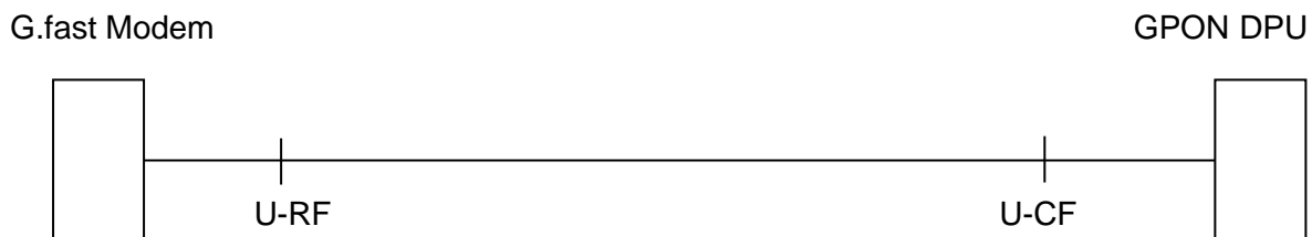
Abbildung 2.4.1 Schematische Darstellung eines G.fast FTTB Anschluss
