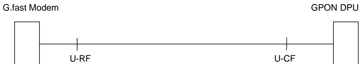
Abbildung 2.4.1 Schematische Darstellung eines G.fast FTTB Anschluss
