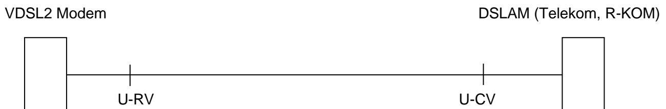
Abbildung 2.3.3 Schematische Darstellung eines VDSL2-Regio Anschluss
