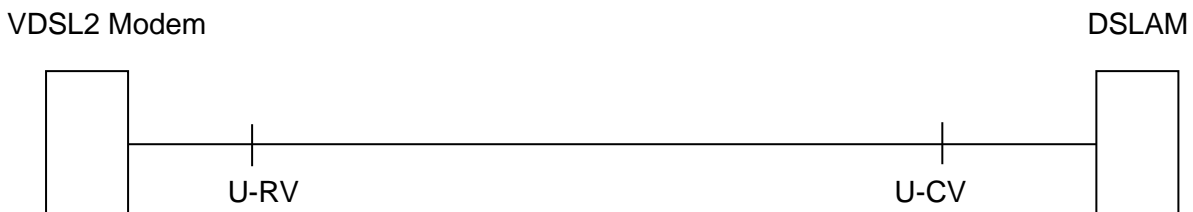
Abbildung 2.3.1 Schematische Darstellung eines VDSL2 FTTC Anschluss
