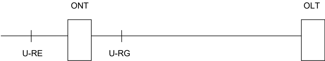
Abbildung 2.4.1 Schematische Darstellung eines GPON (FTTH) Anschluss
