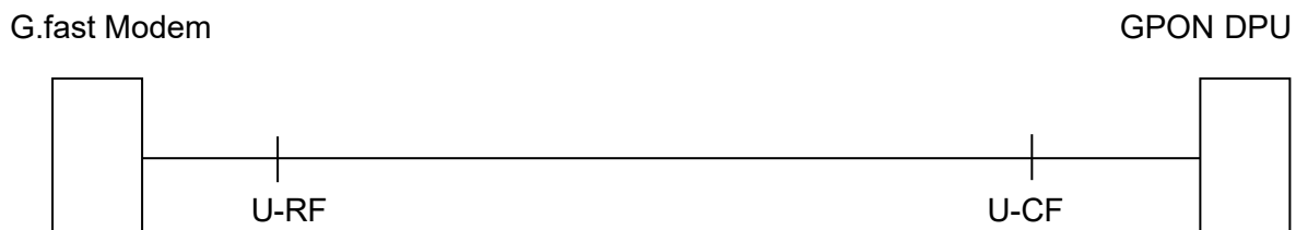
Abbildung 2.4.1 Schematische Darstellung eines G.fast FTTB Anschluss
