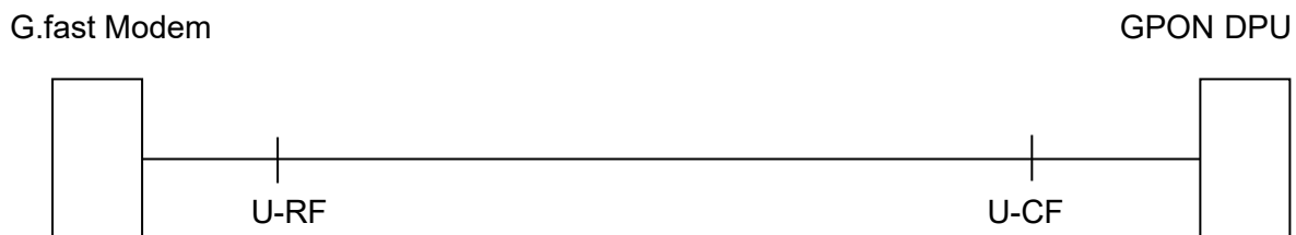
Abbildung 2.4.1 Schematische Darstellung eines G.fast FTTB Anschluss
