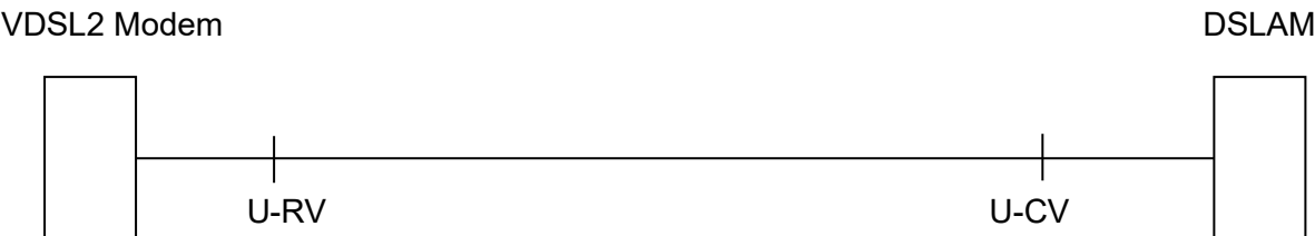
Abbildung 2.3.1 Schematische Darstellung eines VDSL2 FTTC Anschluss
