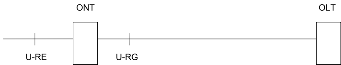
Abbildung 2.4.1 Schematische Darstellung eines XGS-PON (FTTH) Anschluss
